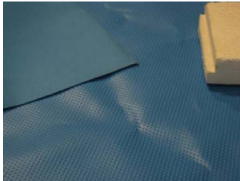
Figur 3. Den nubrede side af gummidugen vendte mod vandsiden, og den glatte side, vist i øverste venstre hjørne, vendte ned mod gulvet
