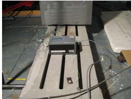
Figur 12. Temperatur mellem betonelement og kunstig gris blev registreret med termoelementer tilsluttet datalogger
