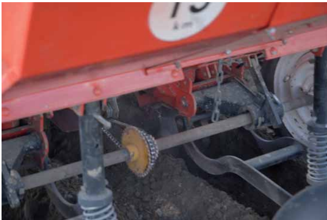
Foto 4. Bejdsning ved lægning med Hardianlæg. Dysen ses over kammen.
