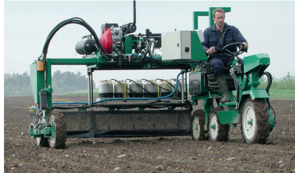
Selvkørende sprøjte fra 00'erne. De nye sprøjter betød en stor rationalisering, da flere led kunne sprøjtes i en arbejdsgang.
