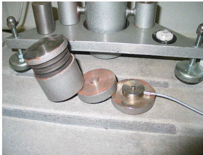
Figur 6. Detailfoto af stødabsorptionsudstyret med krafttransduceren vist nederst
