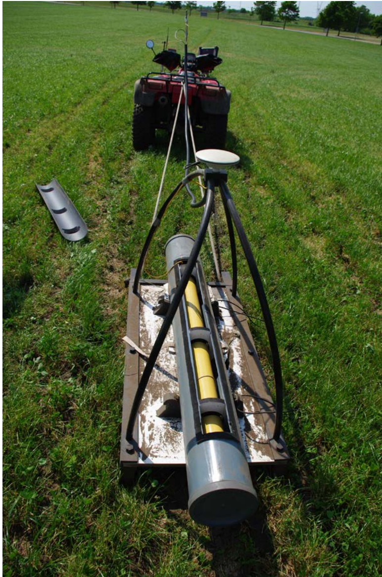
Figur 3. DUALEM-sensoren (gul) monteret på en kunststofslæde. Ovenover sidder GPS antennen til stedfastelsen af målingerne.
